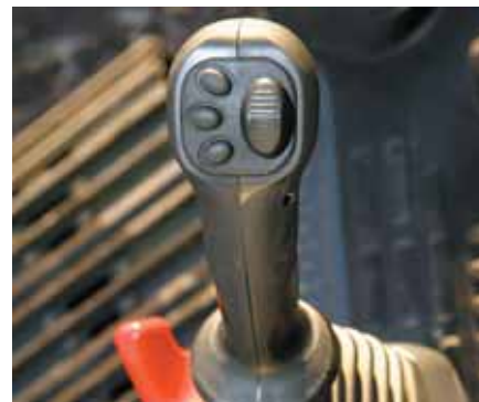
Ovládací joysticky s tlačítky pro proporcionální ovládání příslušenství
